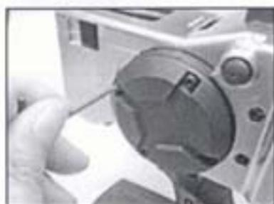
1. Retirer le carter arrière en dévissant les 4 vis de 2.5 mm.
